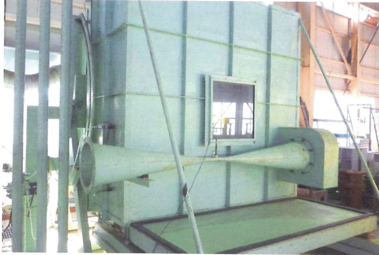
写真 4.1 気密性 試験実施状況
